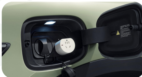
Estación de energía móvil VTOL
